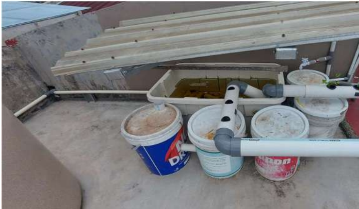
Gambar 10. Contoh rangkaian filtrasi untuk menghasilkan nitrat dari metabolisme ikan (koleksi pribadi)
